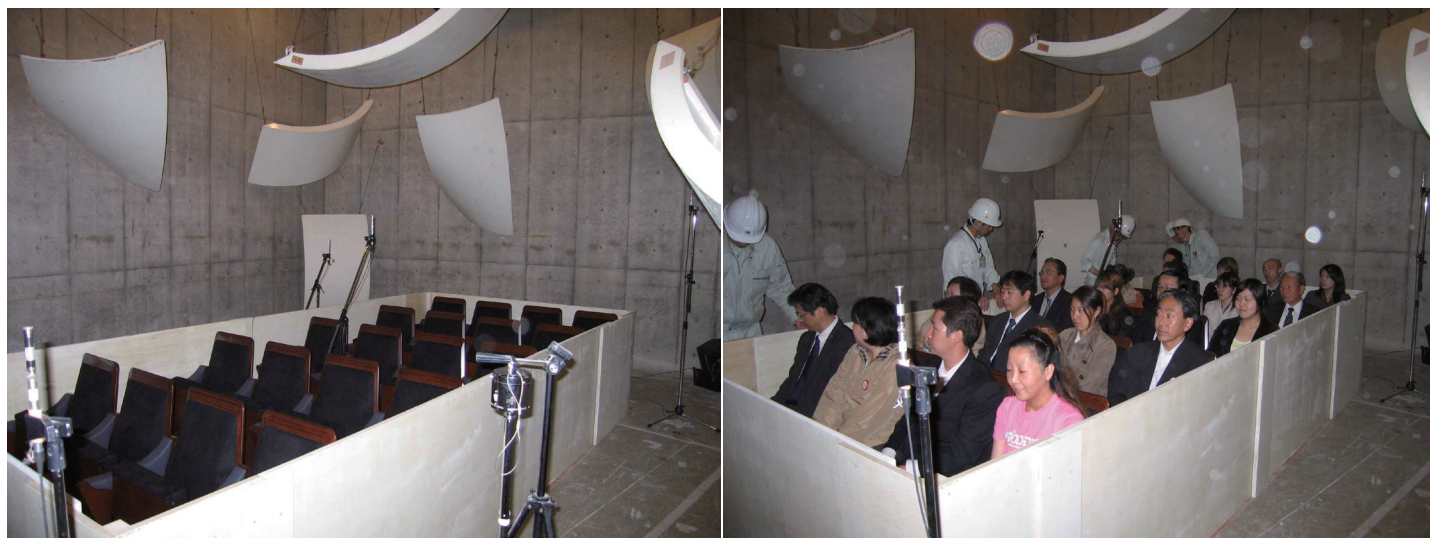
図 残響室法吸音率測定によるホール椅子1脚あたりの等価吸音面積結果
